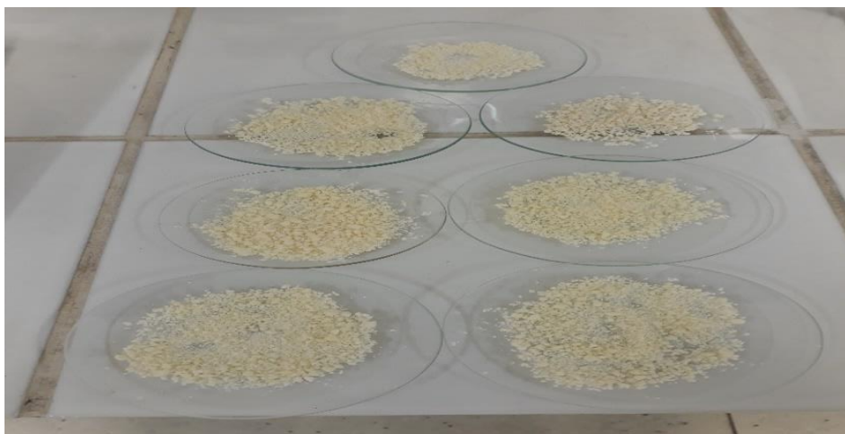
Figura 07: Tensoativo pronto para uso na floculação iônica
