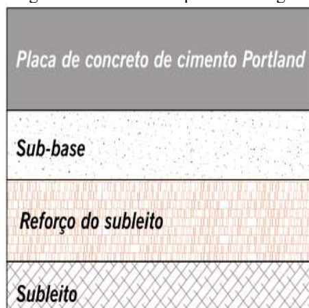
Figura 2 - Camadas do pavimento rígido
