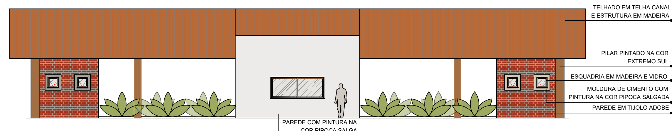
69 FACHADA OESTE - MIRANTE ESCALA: 1/125
