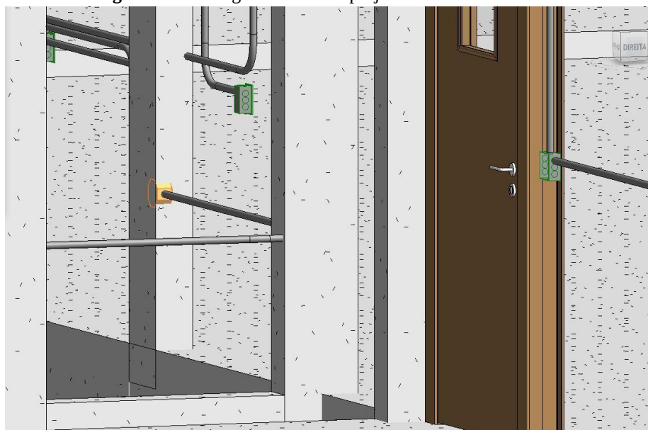
Figura 45 – divergência entre os projetos elétrico e estrutural.
