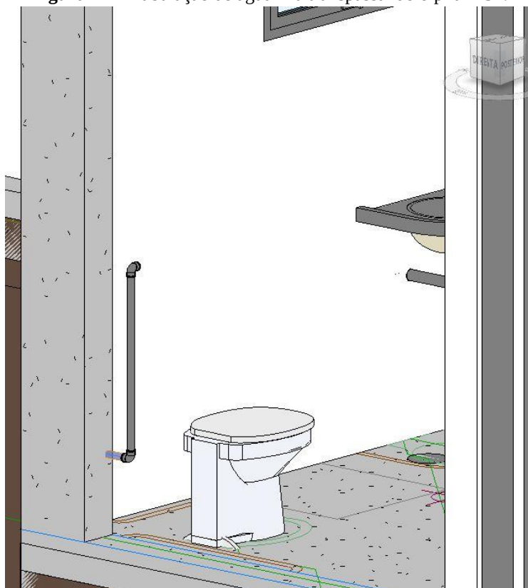
Figura 41 – Tubulação de água fria transpassando o pilar P34.
