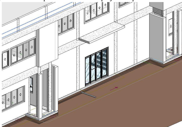
Figura 30 – Incompatibilidade entre os projetos arquitetônico e estrutural.
