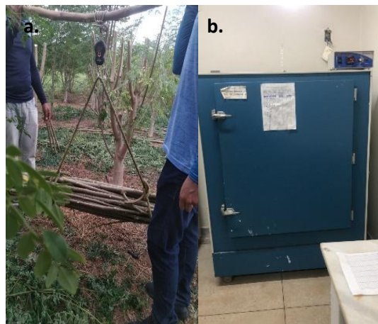
Figura 10: Método de pesagem no campo (A); estufa utilizado para realizar a secagem das amostras (B)
