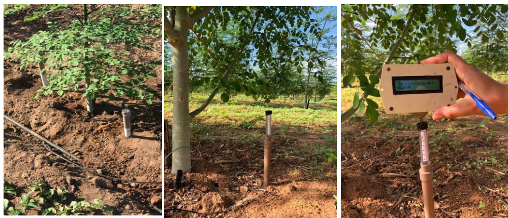
Figura 5: Medição dos Tensiômetro usando tensímetro digital
