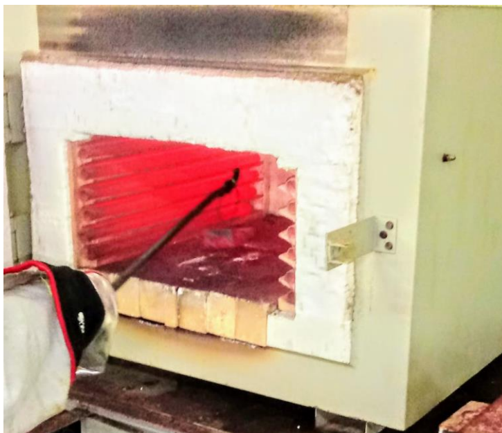
Figura 8 - Tratamento térmico de alívio de tensões
