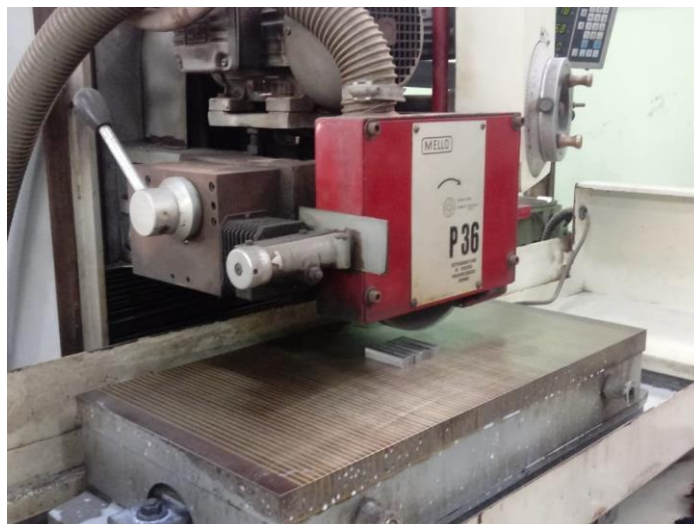
Figura 11 - Usinagem na retificadora plana tangencial
