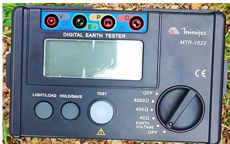
Figura 20: Terrômetro Minipa MTR-1522 utilizado nas medições.
