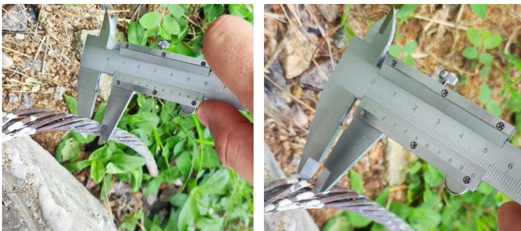
Figura 28: Espessura Medida In loco do Cabo da Malha de Aterramento.
