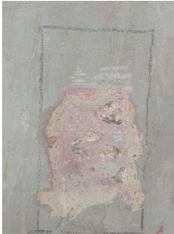
Figura 14: Malha de 5x10 centímetros, aplicado a solução de Fenolftaleína 1%
