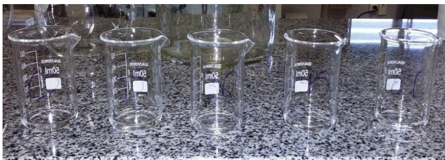
Figura 21: Visão geral (a) 3 ml de solução inibidora antes de adicionar a amostra (b) 7 ml de amostra de água sintética juntamente com a solução inibidora.
