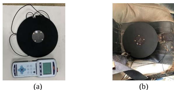
Figura 06 – Representação da instalação do sensor para aquisição do sinal de vibração para o corpo inteiro. (a) Senso a ser usado na coleta de dados. (b) Instalação do senso no banco do veículo.
