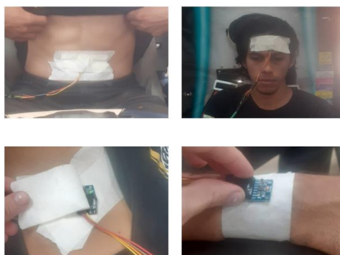
Figura 08 – Amostra de locais onde o sinal da vibração foi captado para as partes localizadas. Autoria própria.
