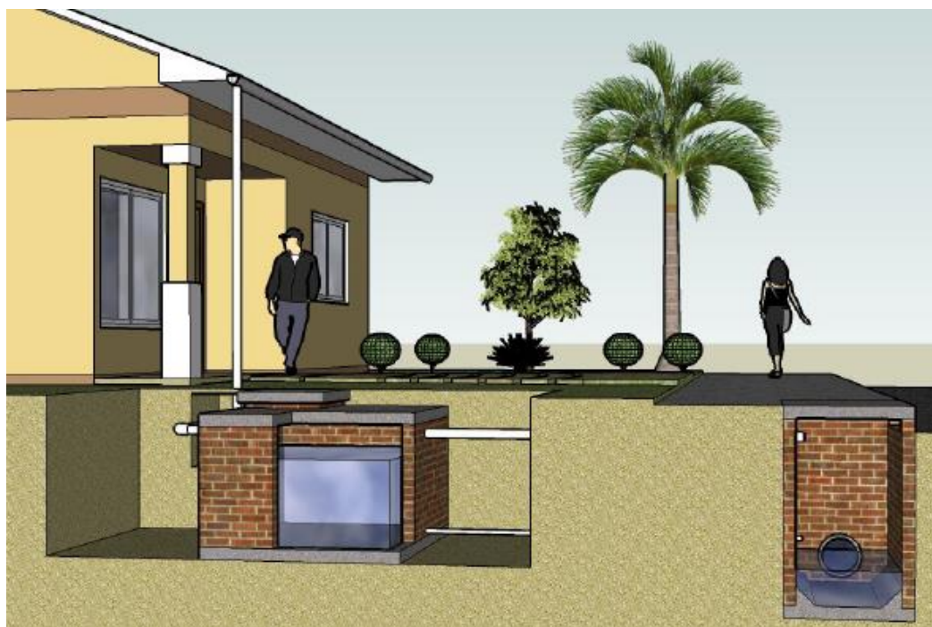
Figura 16 - Croqui do funcionamento de um microrreservatório enterrado
