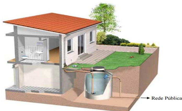
Figura 3 - Croqui de microrreservatório enterrado
