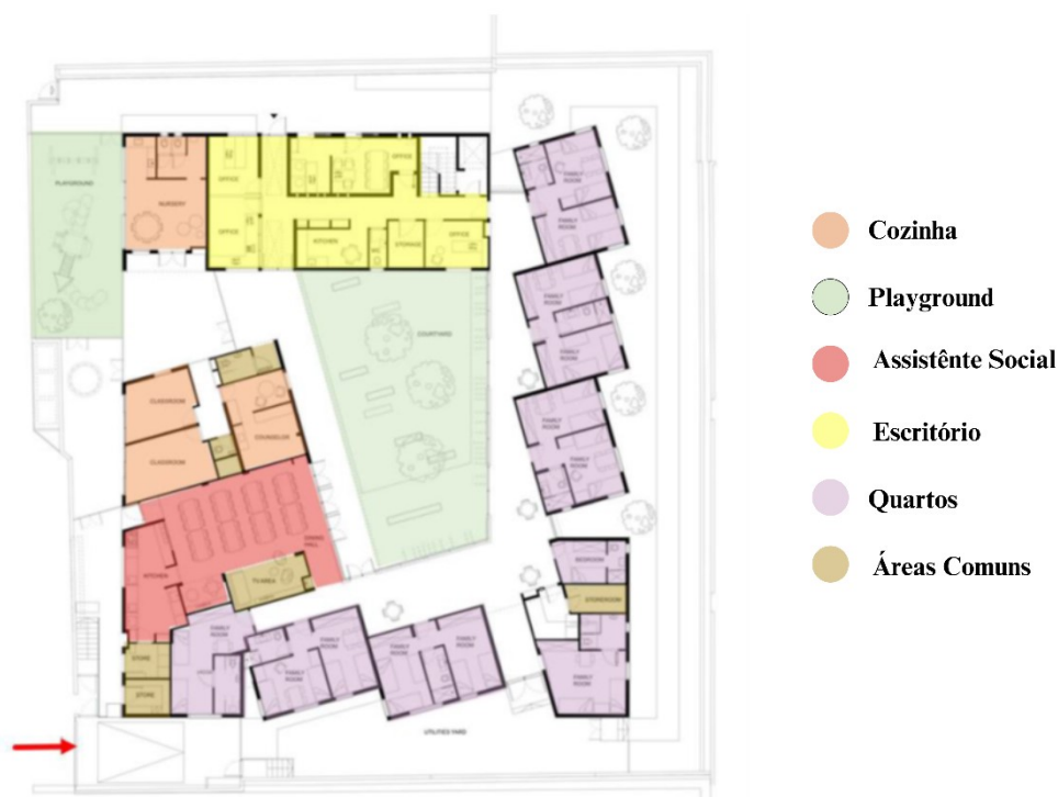
Figura 10: Zoneamento do programa de necessidades do Abrigo.
