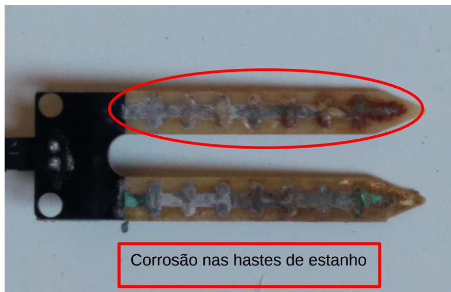
Figura 11: Detalhe do sensor umidade do solo higrômetro após quinze dias de teste
