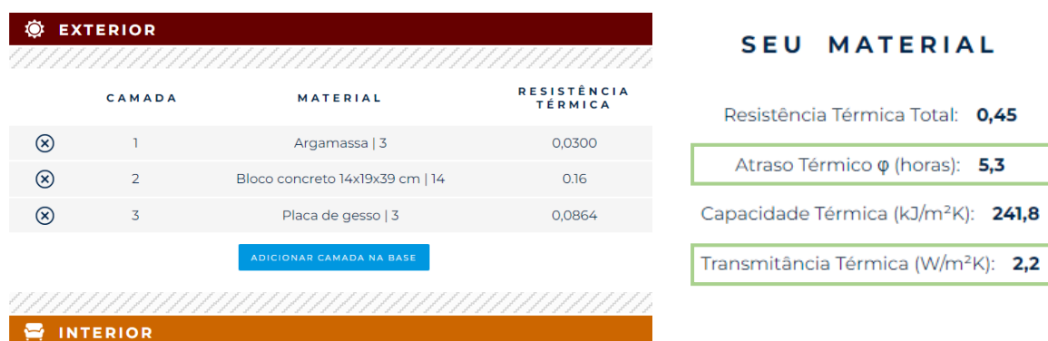
Figura 25 – Componentes construtivos das paredes
