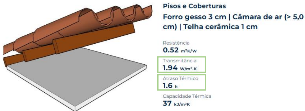
Figura 26 – Componentes construtivos da cobertura
