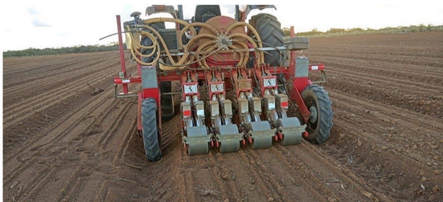
Figura 3. Semeadura mecânica das sementes de cebola
