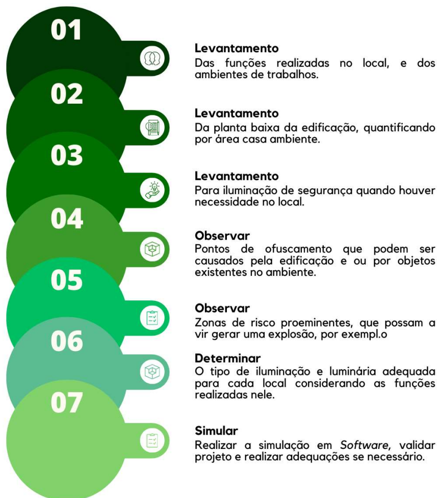
Figura 2 – Fluxograma das etapas de um projeto luminotécnico
