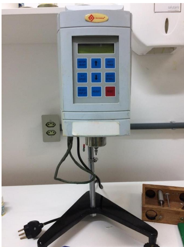
Figura 7 – Viscosímetro rotativo Quimis Modelo XYZ.
