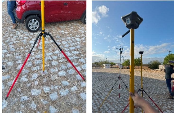
Figura 6 – Estabilização da base do GPS/RTK.
