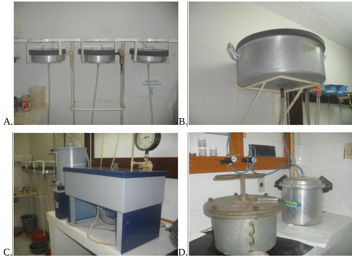
Figura 2 – Mesa de tensão de placa porosa de areia (A e B); Mesa de tensão de placa porosa de argila (C); Câmara de pressão com placa porosa (D). Mossoró-RN, 2010.
