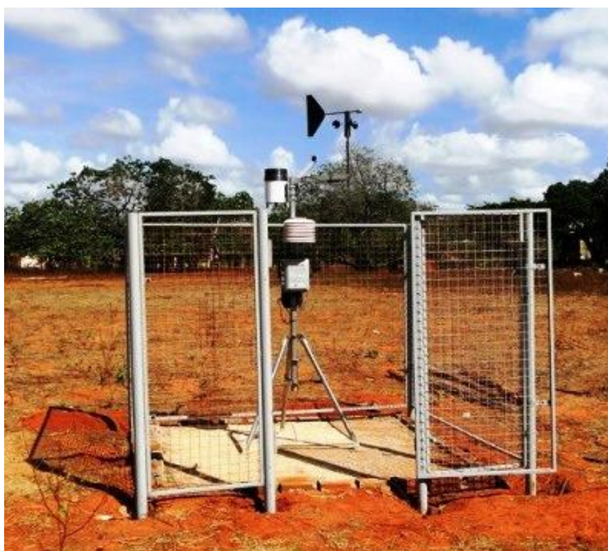
Figura 14. Estação Meteorológica do CETAPIS instalada na Fazenda Experimental Rafael Fernandes, localizada na comunidade Alagoinha, Zona Rural de Mossoró-RN.
