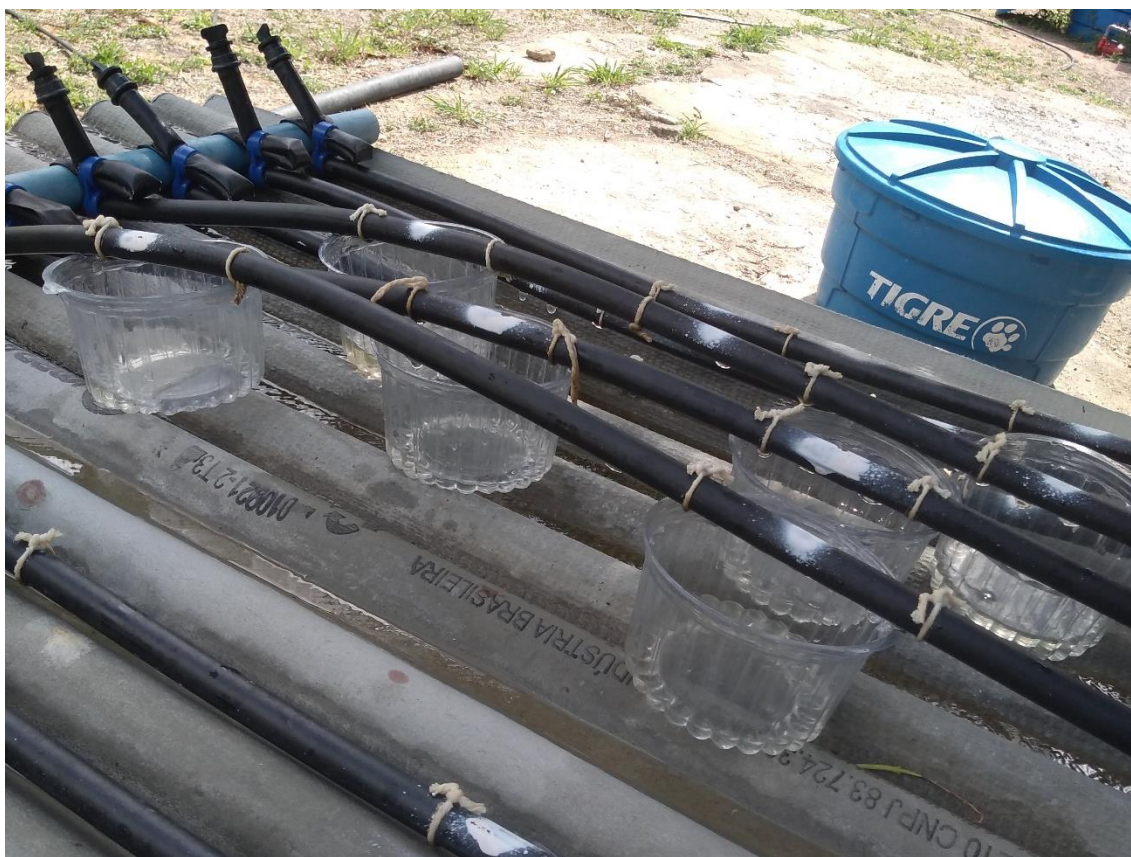
Figura 6. Avaliação de desempenho hidráulico dos gotejadores.
