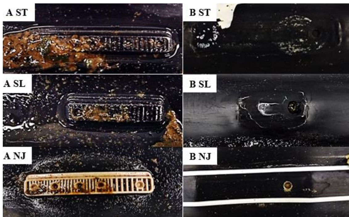
Figura 14. Foto da parte interna (A) e externa (B) dos gotejadores ST, SL e NJ operando com a diluição D2.
