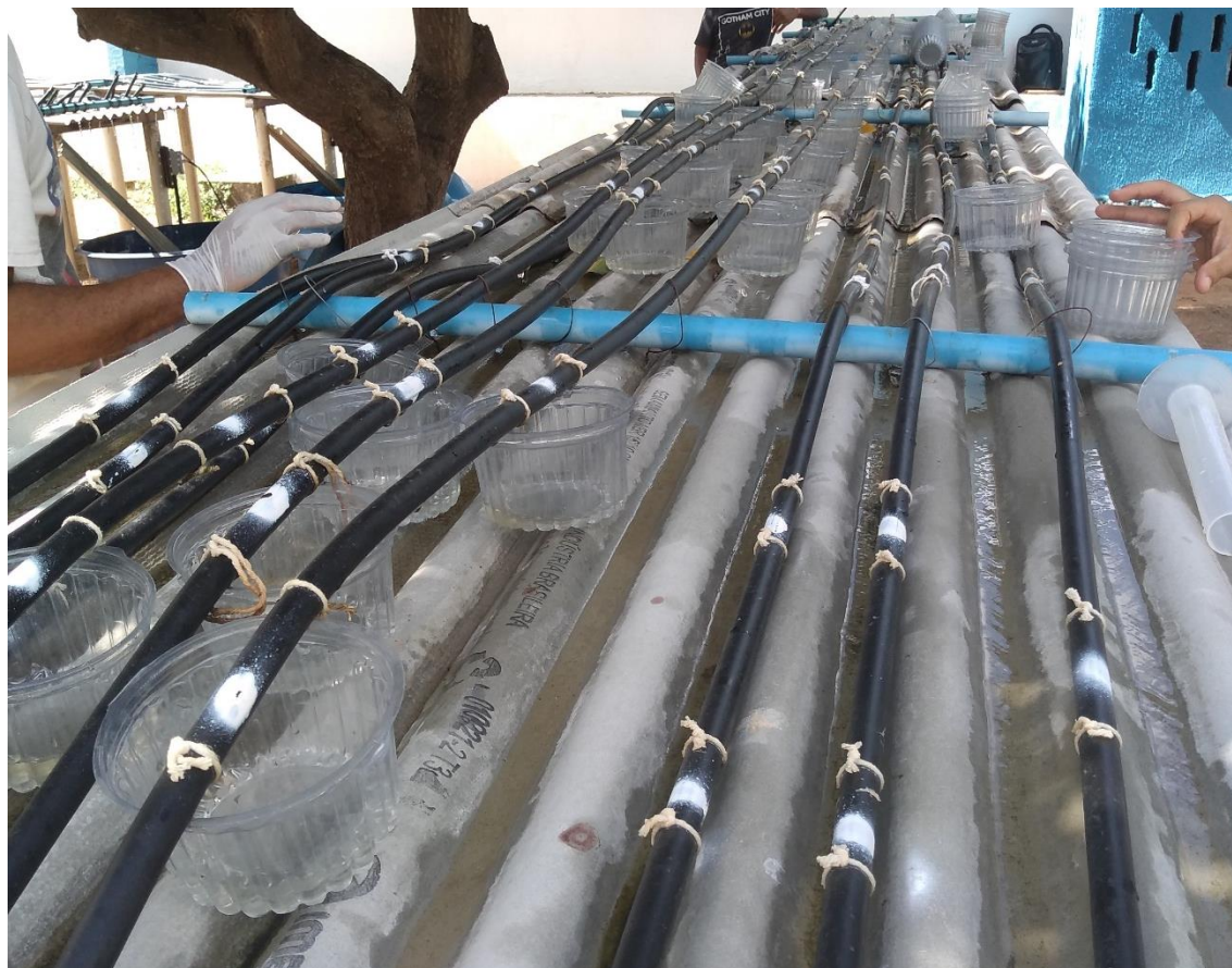
Figura 6. Avaliação de desempenho hidráulico dos gotejadores.
