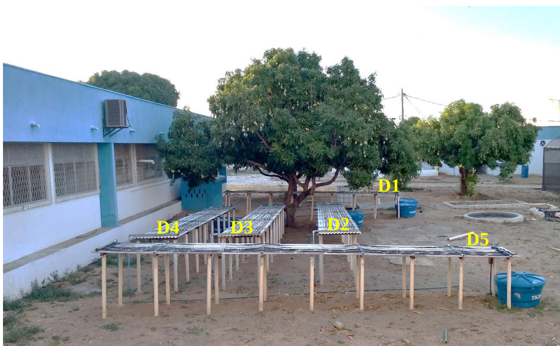
Figura 3. Bancadas experimentais para avaliação do desempenho hidráulico dos emissores.
