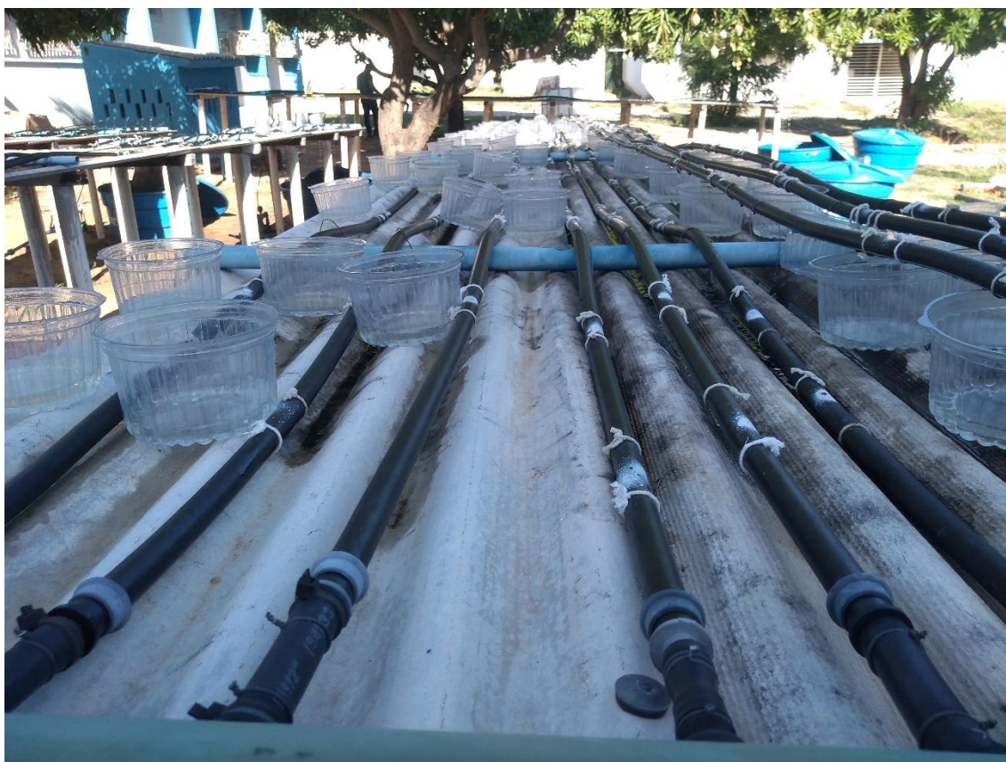
Figura 6. Avaliação de desempenho hidráulico dos gotejadores.
