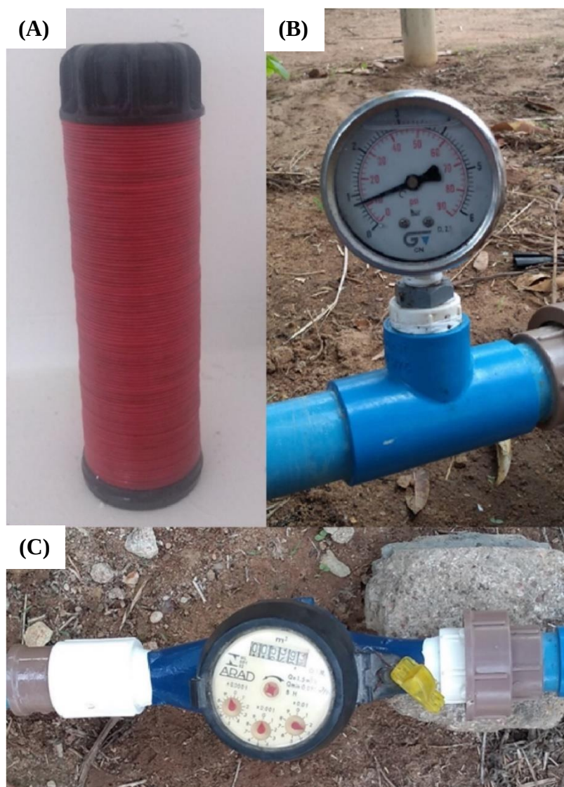
Figura 8. (A) filtro de disco com aberturas de 130 \mu\text{m} ; (B) manômetro analógico de glicerina (0 a 400 kPa); (C) hidrômetro.
