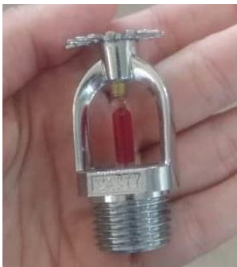
Figura 7 - Sprinkler utilizado em uma obra de construção civil na cidade de Mossoró - RN, 2018.
