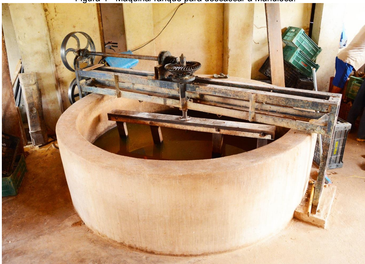
Figura 4 - Máquina/Tanque para descascar a Mandioca.
