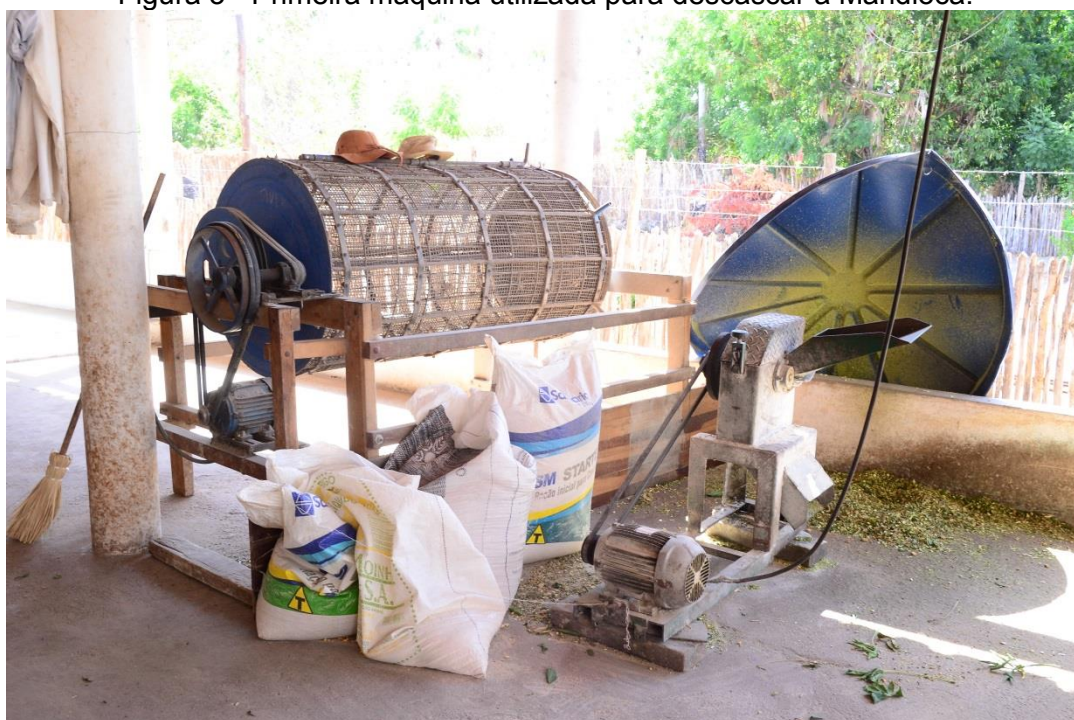
Figura 3 - Primeira máquina utilizada para descascar a Mandioca.
