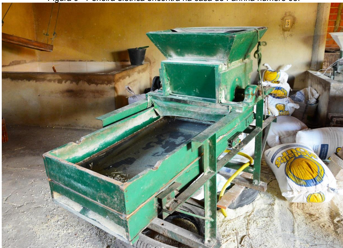
Figura 9 - Peneira elétrica encontra na casa de Farinha número 03.
