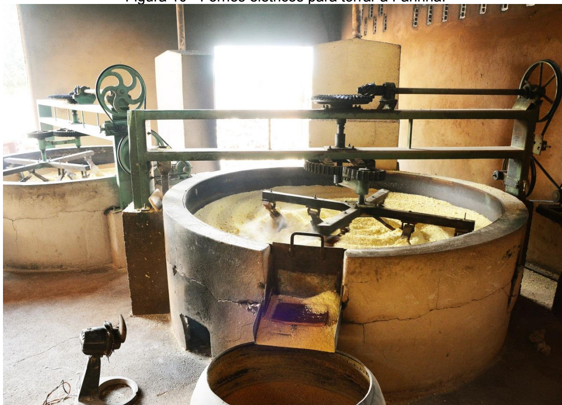
Figura 10 - Fornos elétricos para torrar a Farinha.
