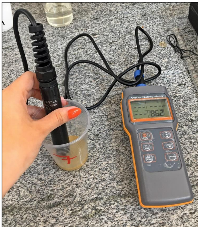
Figura 19 – Leitura da condutividade elétrica
