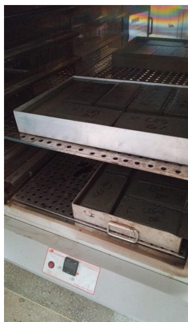
Figura 21: Traços REF-CES e CPV-CES cura na estufa e submersa a água
