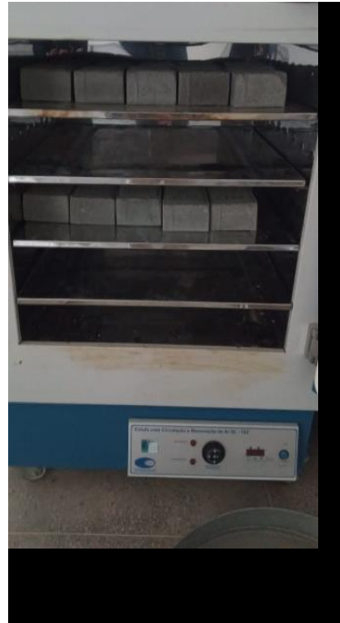
Figura 20: Traços REF-CE e CPV-CE cura na estufa
