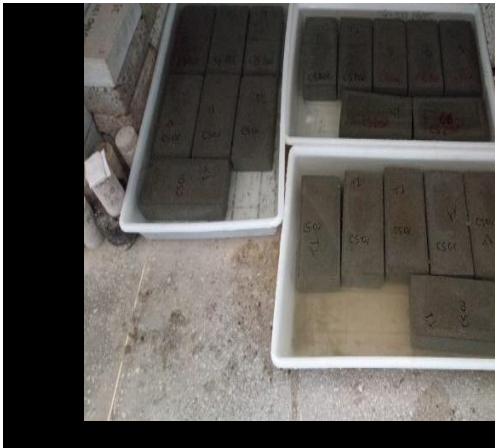
Figura 19: Traços REF-CS e CPV-CS na cura submerso a água.
