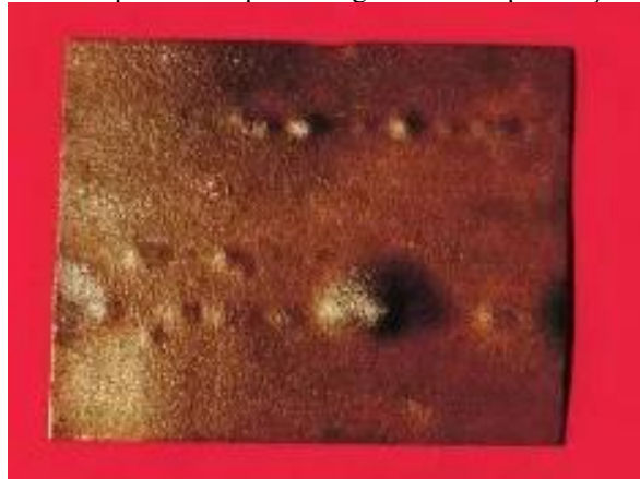
Figura 11 - Empolamento por hidrogênio em chapa de aço carbono
