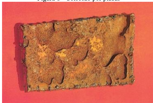
Figura 6 - Corrosão por placas
