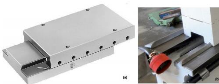
Figura 4 - (a) Barramento rabo de andorinha e (b) prismática em V.
