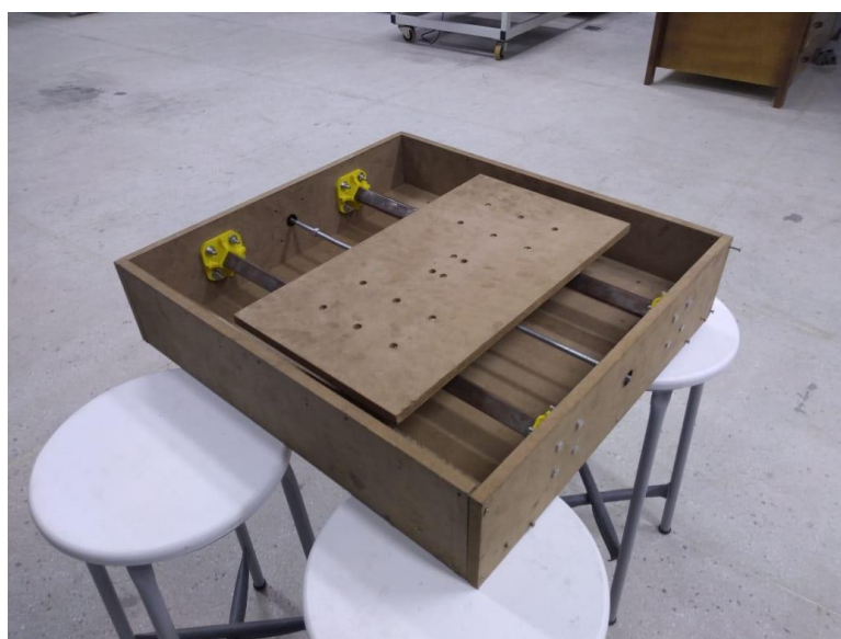
Figura 31 - Estrutura mecânica do eixo X montada
