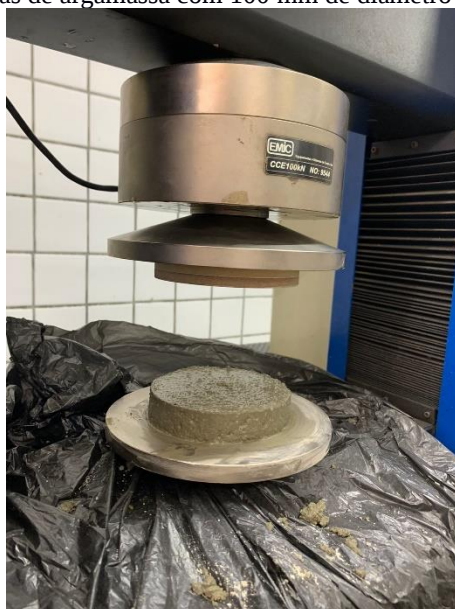
Figura 7: Amostras de argamassa com 100 mm de diâmetro e 20 mm de altura
