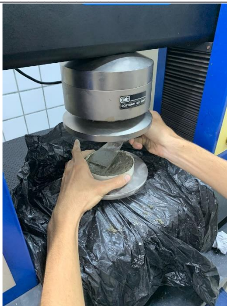
Figura 7: Amostras de argamassa com 100 mm de diâmetro e 20 mm de altura
