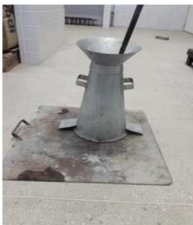
Figura 19: Conjunto Slump test (teste da trabalhabilidade)
