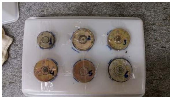
Figura 16: Ímãs de geometria anel usados para o tratamento da água
