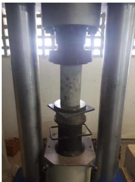
Figura 24: Rompimento dos CP's com a prensa EMIC SSH300
