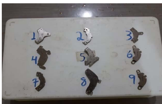
Figura 17: Ímãs de geometria L usados para o tratamento da água
