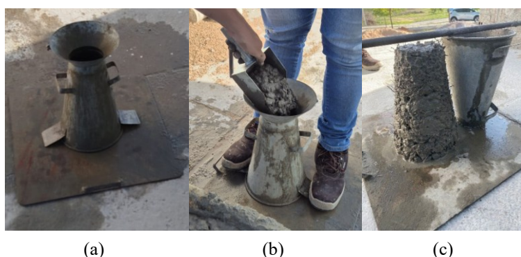
Figura 23- Ensaio de Slump Test : a) equipamento preparado para o ensaio; b) lançamento e adensamento do concreto; e c) medição da consistência
