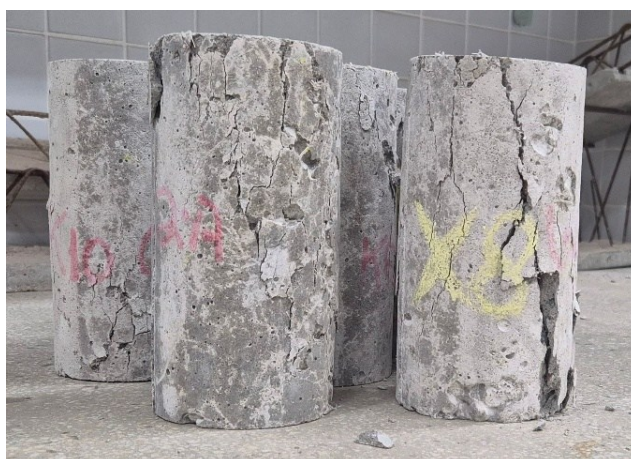
Figura 43- Tipos de ruptura dos CP do traço A (0,20%)
