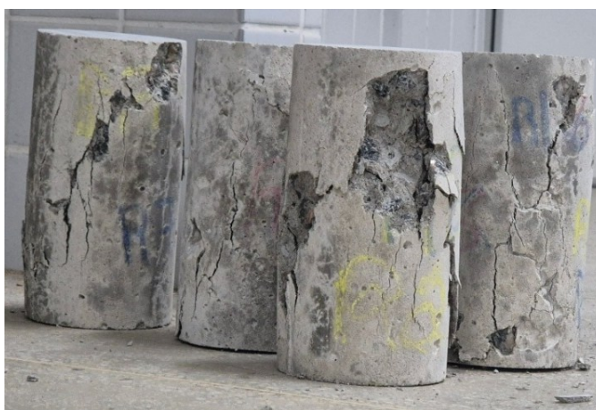
Figura 42- Tipos de ruptura dos CP do traço REF
