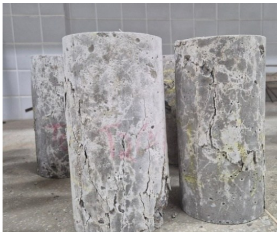
Figura 44- Tipos de ruptura dos CP do traço B (0,35%)
