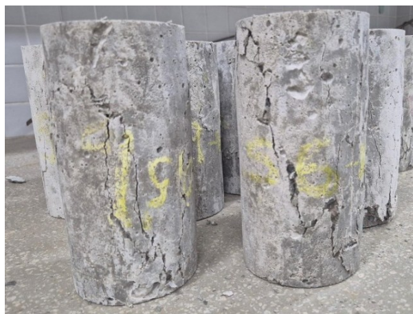
Figura 45- Tipos de ruptura dos CP do traço C (0,50%)
