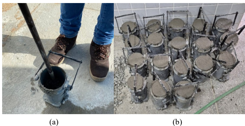
Figura 24- Moldagem dos corpos de prova: a) adensamento manual do concreto; e b) corpos de prova moldados
