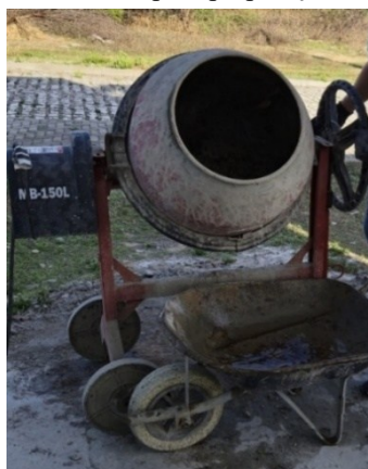
Figura 21- Betoneira para preparação do concreto
