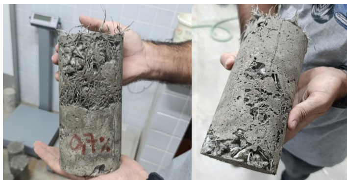
Figura 40- Traço de 0,70% com formação de agrupamentos de fibras
