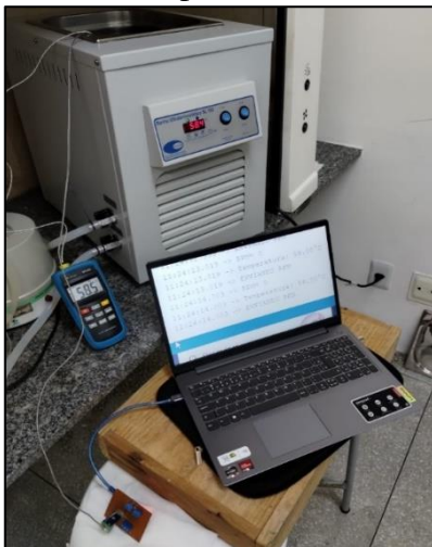
Figura 30 - Sistema para ensaio de temperatura
