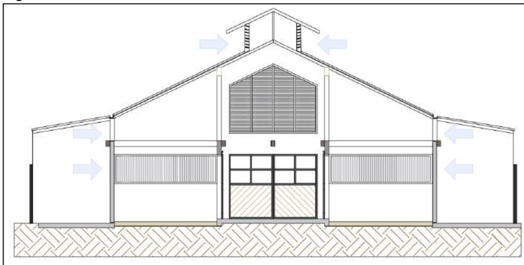
Figura 9 — Fluxos de Ar em Estábulo com Lanternim.
