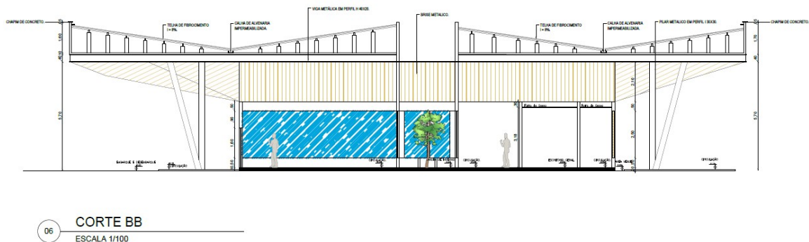
Figura 62 – Corte BB, detalhando os elementos vazados.
