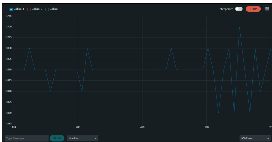
Figura 37 – Leituras dos deslocamentos eixo X plotadas através da “Ploter Serial”
