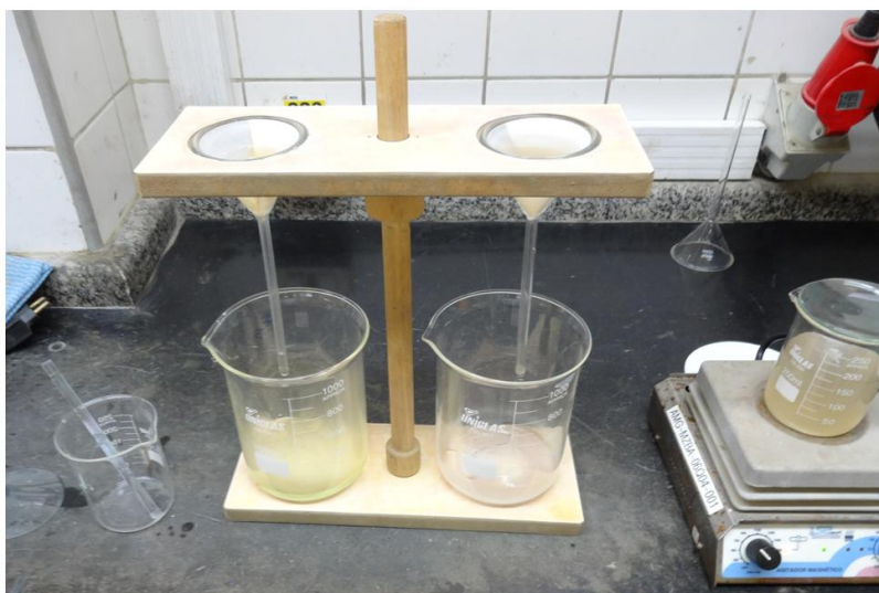
Figura 12 – Processo de filtragem do material
