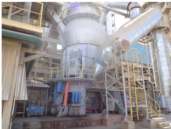
Figura 04 – Moinho vertical utilizado para moagem do cru
