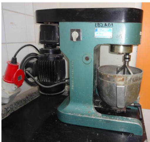
Figura 16 – Argamassadeira em operação.
