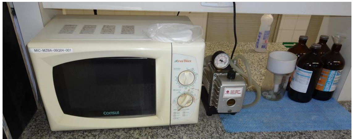
Figura 15 – Micro-onda, bomba a vácuo e frasco de etileno glicol neutralizado
