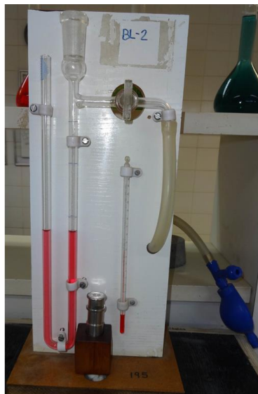
Figura 13 – Permeabilímetro para encontrar o valor do Blaine
