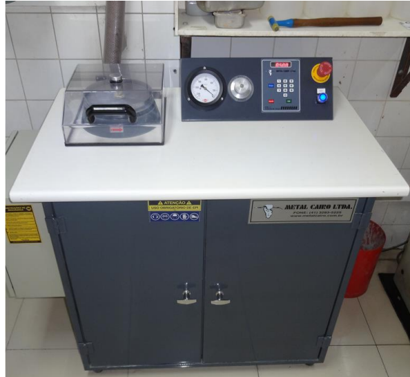
Figura 14 – Peneira rotativa aerodinâmica
