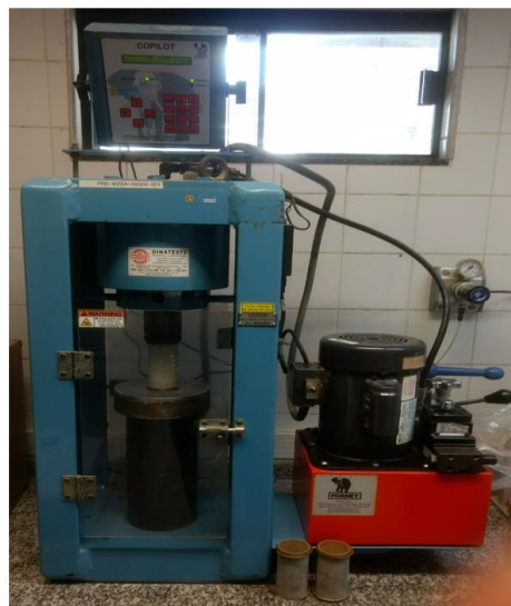
Figura 18 – Aparelho de ruptura dos corpos de prova
