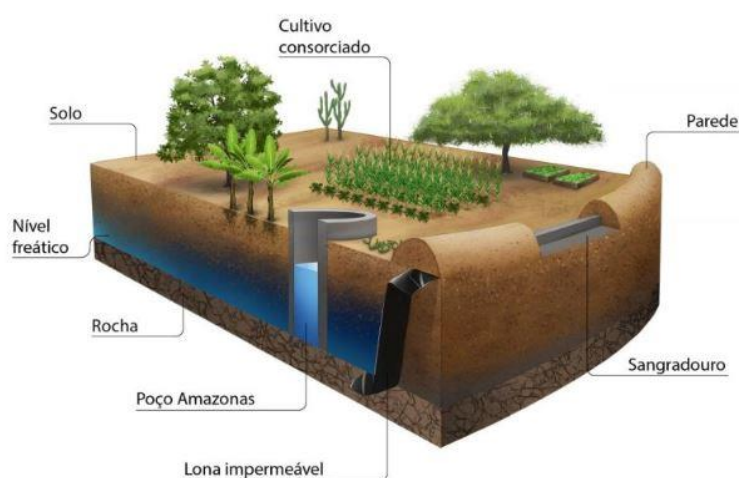
Figura 9. Desenho esquemático de uma barragem subterrânea.
