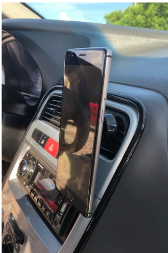
Figura 12 – Smartphone fixado no painel do carro com o suporte do tipo magnético
