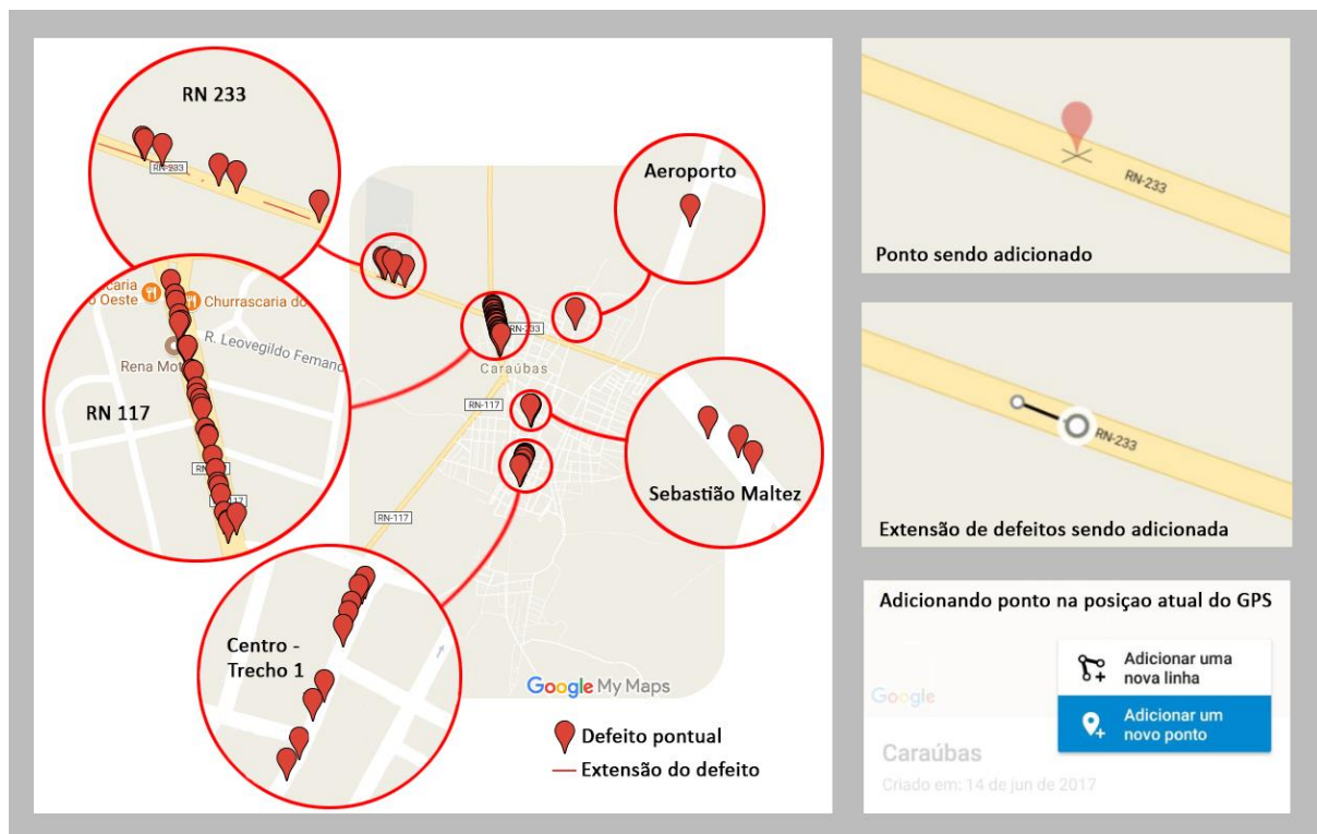
Figura 11 – Defeitos catalogados sendo adicionados pelo aplicativo Google My Maps
