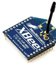
Figura 3 – Módulo XBee. Fonte: (ARDUINO, 2014).
