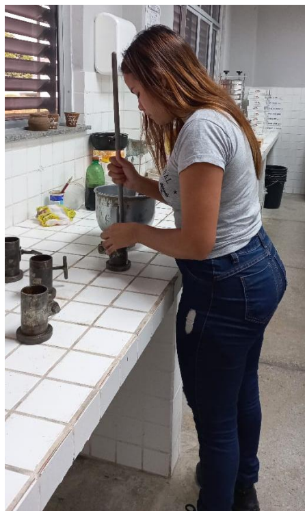
Figura 1 - Preparação da mistura da argamassa
