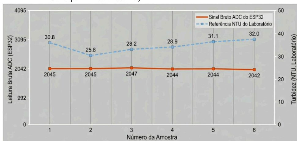
Figura 25 - Gráfico diagnóstico do sensor de turbidez falho (Leitura bruta do adc do esp32 x laboratório)
