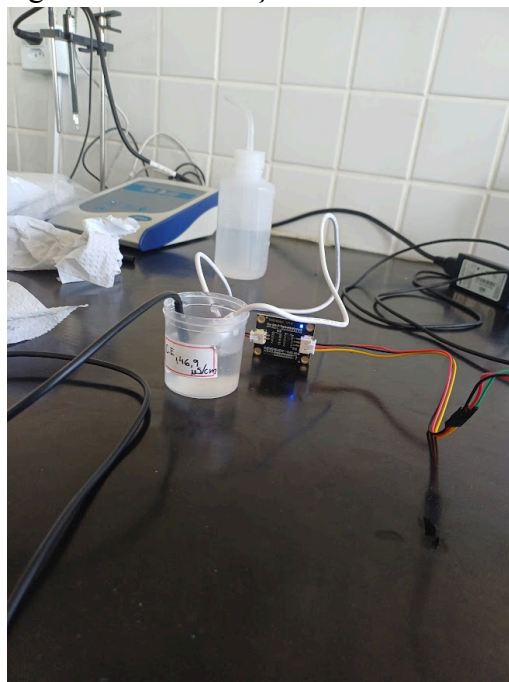
Figura 17 - Calibração sensor condutividade elétrica
