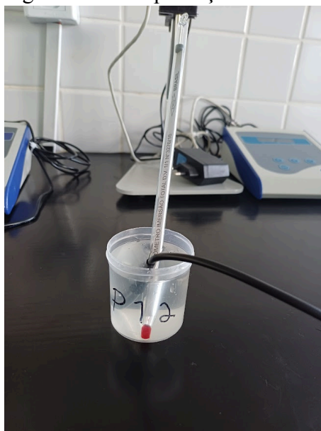
Figura 16 - Comprovação da calibração sensor de temperatura
