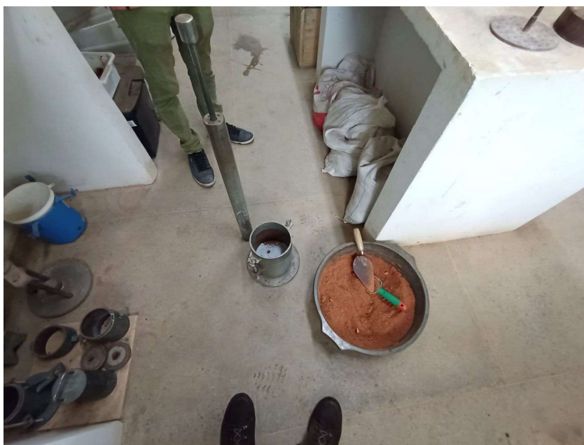
Figura 12 – Ferramentas utilizadas no ensaio de compactação
