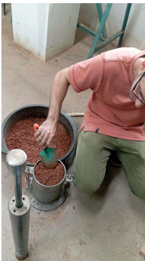
Figura 14 – Preenchimento das camadas para compactação
