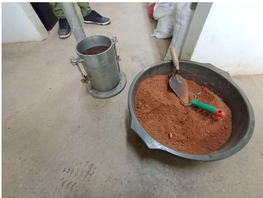
Figura 13 – Cilindro utilizado no ensaio de compactação
