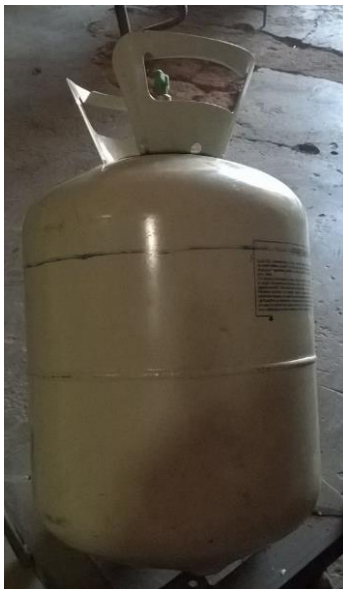
Figura 12: Tambor de gás para ar condicionado.
