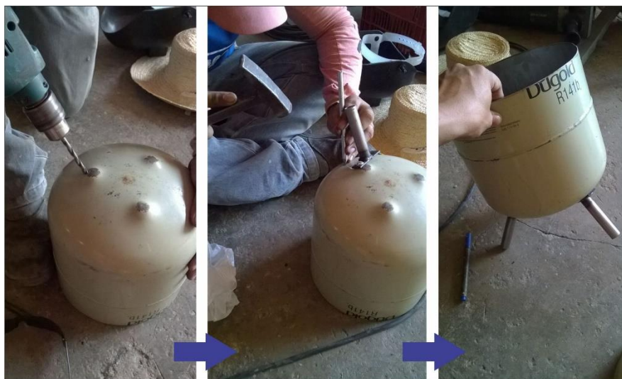
Figura 15: Processo de fixação dos pés a base do forno.
