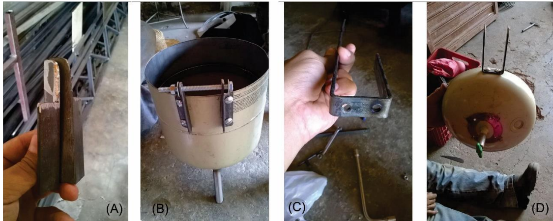
Figura 16: Sequência de passos para construção da dobradiça.
