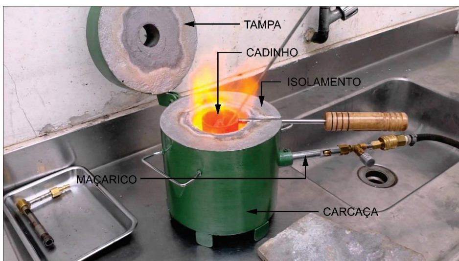
Figura 9: Forno a Cadinho.
