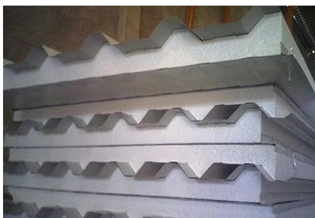
Figura 4.3: Painéis monolíticos de EPS do tipo ondulado.
