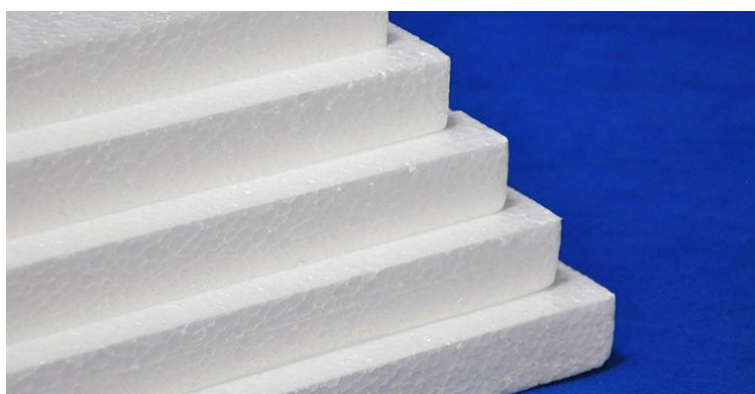
Figura 4.2: Painéis monolíticos de EPS do tipo retangular.
