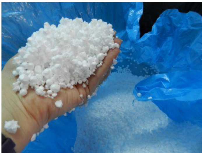
Figura 4.20: Eps em formato de “flocos” após processo de trituração.
