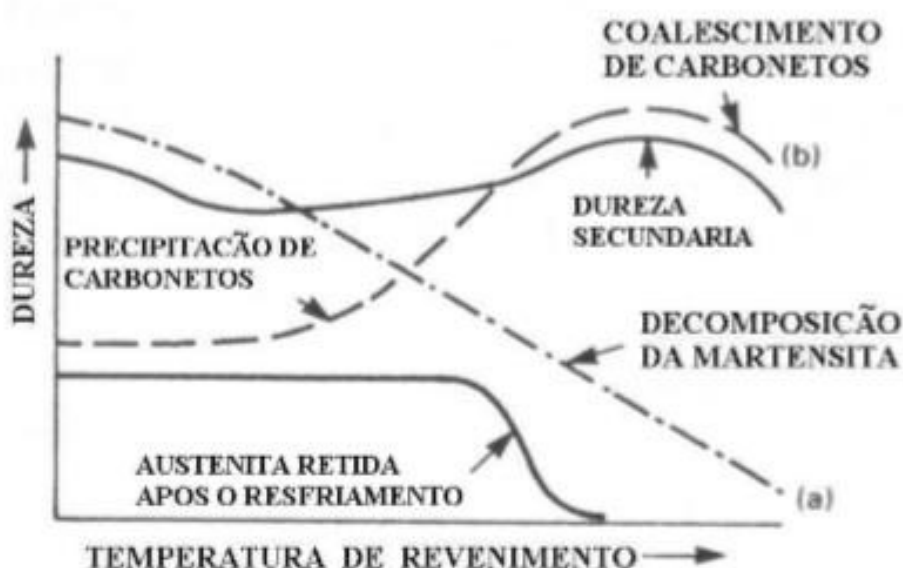
Figura 1 - Efeito da temperatura de revenimento na dureza de um aço ferramenta
