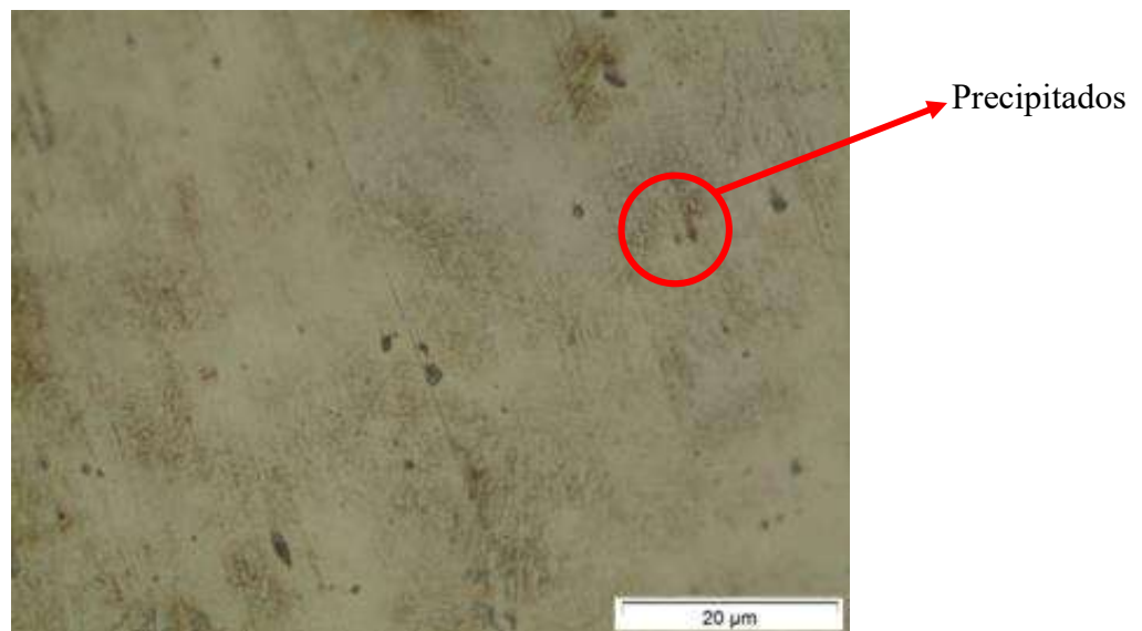
Figura 10 - Fotomicrografia da amostra 13 (Temperada à 1050°C e revenida à 400°C) com aumento de 1000x
