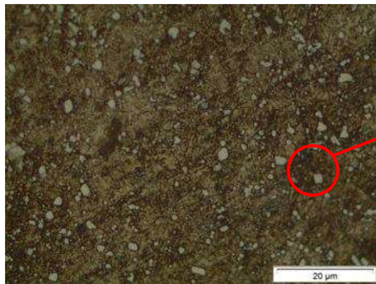
Figura 12 - Fotomicrografia da amostra 23 (Temperada à 1050°C e revenida à 600°C) com aumento de 1000x
