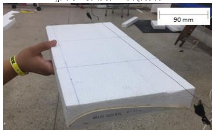
Figura 5 – Corte com fio aquecido
