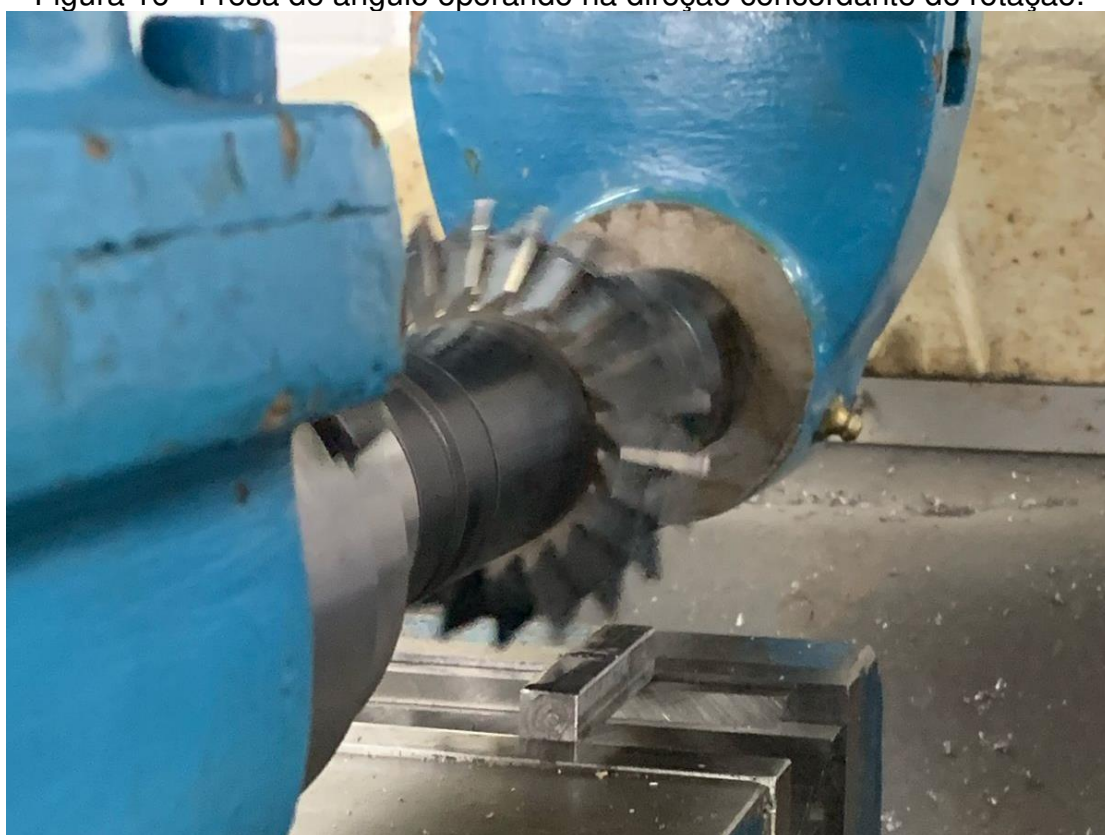
Figura 16 - Fresa de ângulo operando na direção concordante de rotação.
