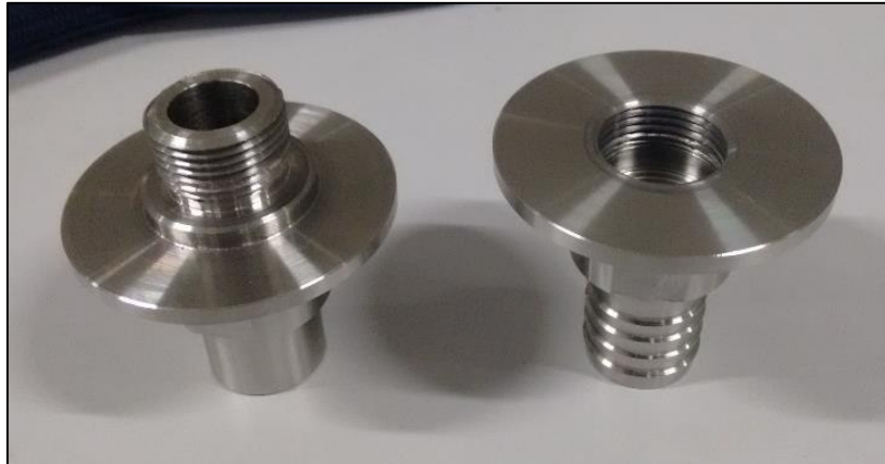
Figura 26 – Flanges em Aço inoxidável AISI 304 confeccionados nos SENAI-RN
