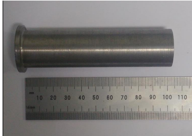
Figura 13 – Inspeção de tolerância do corpo de prova após a usinagem.
