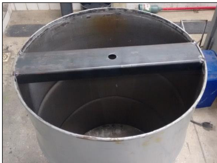
Figura 25 – Tambor metálico com base superior soldada
