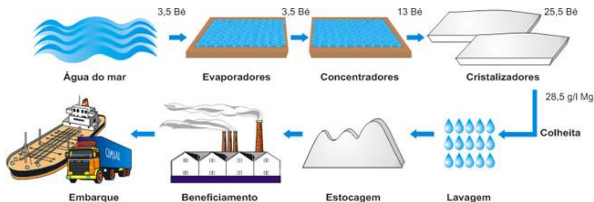
Figura 5: Esquema de etapas na produção do sal marinho
