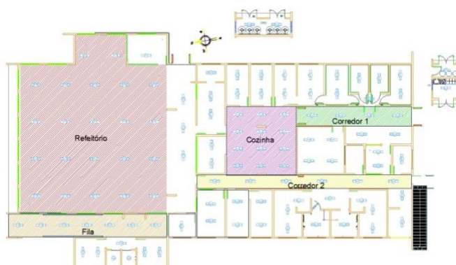
Figura 29 - Ambientes com acionamento de iluminação por disjuntores
