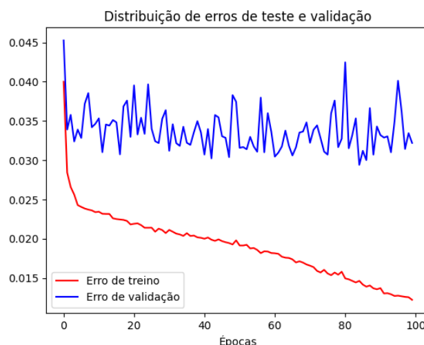
Figura 8 - Comparação entre os erros de treinamento e validação com o modelo LSTM (Fonte: Autoria própria)
